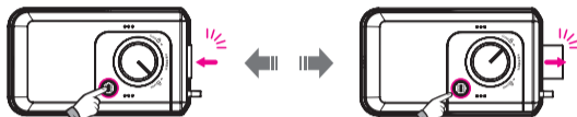
잠겨 있을 때 [잠금/열림] 버튼을 누르면 열림, 열려 있을 때 [잠금/열림] 버튼을 누르면 잠금
