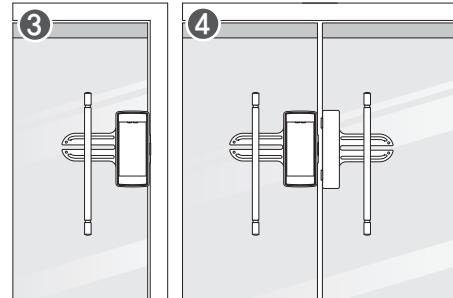
③ 좌수문 설치 시 (180도 회전 설치)
